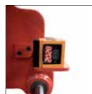
4 Capteurs de préhension Détection du type et de la configuration de la charge en hauteur / profondeur, ainsi que de sa distance par rapport au corps de la pince
